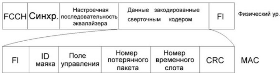
Рисунок 7. Структура пакета запроса на повторение передачи.
