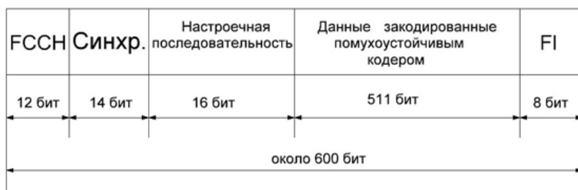
Рисунок 9. Структура пакета физического уровня.
