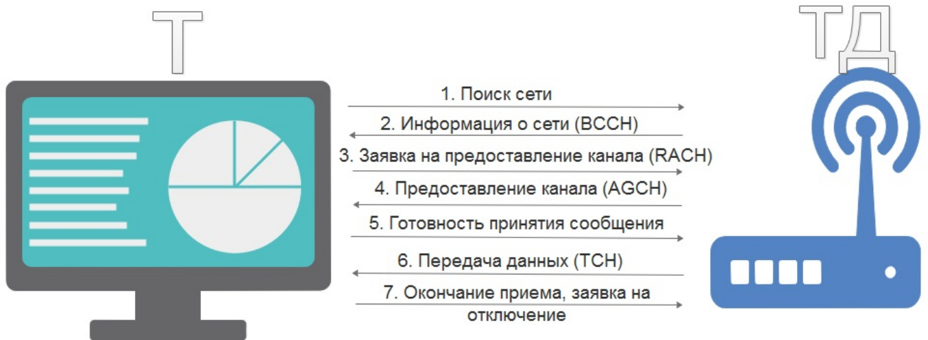
Рисунок 5. Сценарий установления соединения и доставки сообщений.
