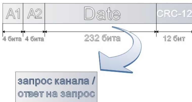
Рисунок 9. Пакет канального уровня для передачи служебных сообщений
