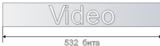
Рисунок 7. Пакет канального уровня для передачи информационных сообщений
