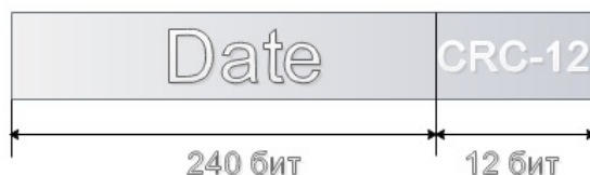
Рисунок 8. Пакет канального уровня для передачи широковещательных сообщений
