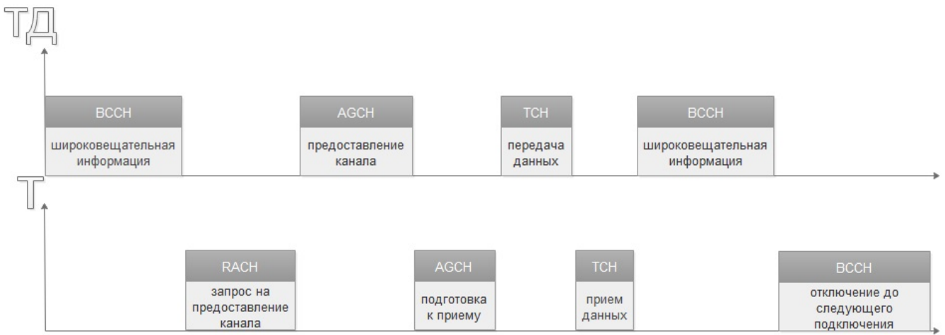
Рисунок 3. Взаимодействие терминала с ТД
