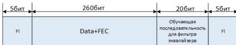
Рис.6 Структура L1-пакета с учетом размеров
