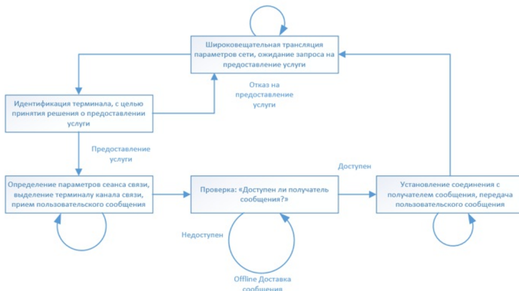
Рисунок 6. Диаграмма состояний базовой станции.
