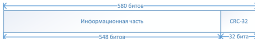
Рисунок 11. Структура пакета сообщения трафика L2 уровня.
