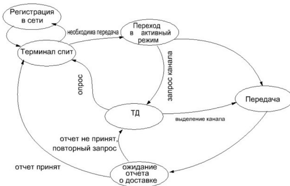
Рис.1. Сценарий взаимодействия терминала и ТД при передаче информации от терминала точке доступа. Если терминалу нужно передать данные, он дожидается опроса от ТД данной сети. После опроса ТД данного терминала, он переходит в активный режим и запрашивает канал для передачи информации. Данной ТД выделяется канал связи и происходит передача данных. Далее терминал ожидает отчет о доставке. Если отчет принят(данные успешно передались), терминал переходит в спящий режим. Если отчет не принят(данные не передались, либо передались с ошибкой), терминал отправляет запрос ТД на повторную передачу.
