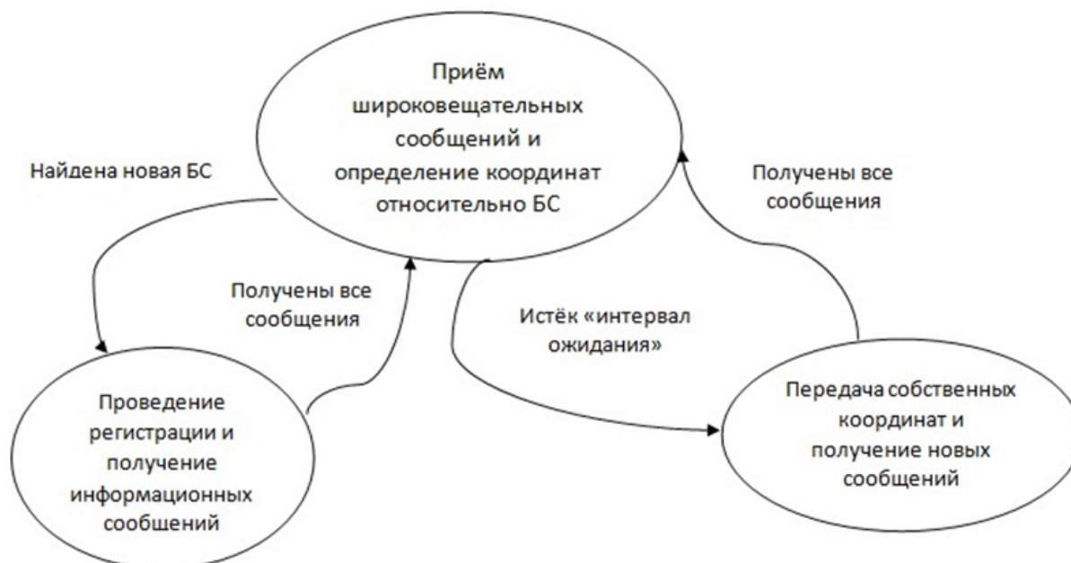
рис. 11 – диаграмма состояний терминала
