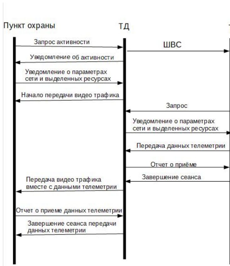
рис.4 . Трехзвневая модель взаимодействия элементов сети
