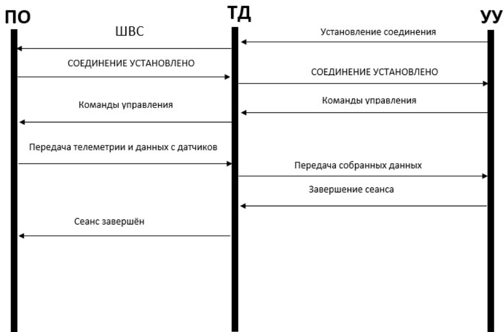
Рисунок 7 Трехзвеневая схема взаимодействия элементов сети
