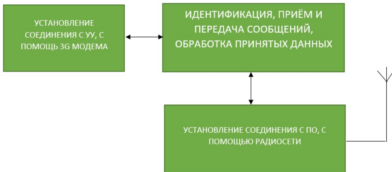
Рисунок 9 Функциональная схема ТД
