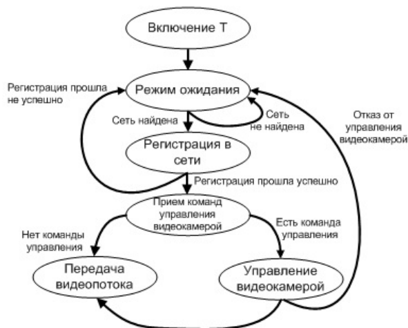
Рис. 5. Диаграмма состояний терминала.
