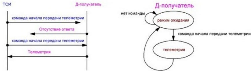
Рис.13. Сценарий взаимодействия и диаграмма состояний датчиков в режиме передачи данных телеметрии.
