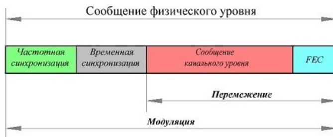
Рис. 8 Структура пакета физического уровня.
