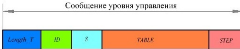
Рис. 9. Структура пакета уровня управления для сообщения маршрутизации.
