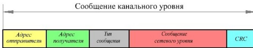
Рис. 7 Структура пакета физического уровня
