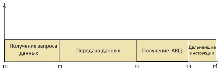
Рис. 2 Организация доступа к физическому каналу
