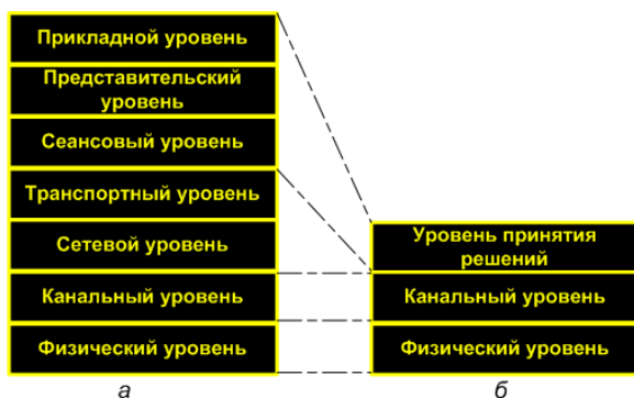
Рисунок 3- Иерархическая структура: а- эталонная модель, б- разрабатываемая модель.
